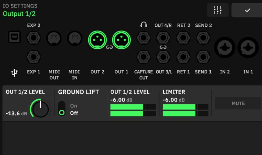
未使用のインプットはグレー、使用しているインプットは白、選択しているインプットは緑でハイライトされます。何かを接続すると、グレーの入力が瞬時に白くハイライトされます。ジェスチャーやロータリー・フットスイッチを使用しパラメーターを変更することが可能です。
